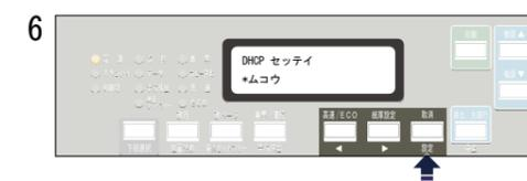
DHCPを有効にした場合、以上でネットワーク設定は終了です。印刷スイッチを押して、微調▲スイッチで設定登録します。初期診断テストが実行されます。
