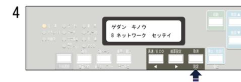
※電源をオンにした直後に手順3.を実行すると「8 ネットワーク セッテイ」が表示されずネットワークの設定できません。表示されない場合は印刷スイッチを押してメニューモードから抜けて、暫く待ってから再度手順3.から実施してください。
